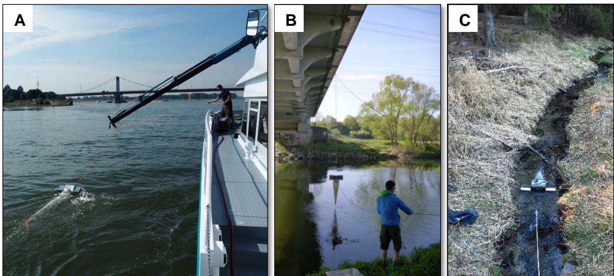
Abbildung 4: Beprobung der Wasseroberfläche von Fließgewässern mittels „MiniManta“-Trawl (A) vom Schiff, (B) von einer Brücke, (C) vom Ufer Bildquelle: (A)+(B) LANUV, (C) Universität Bayreuth
