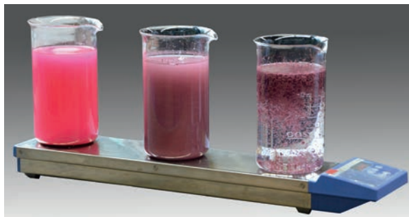
Flockung von Mikroplastik (links: suspendiertes Mikroplastik; mittig: Flockungsvorgang; rechts: zur Oberfläche treibende Mikroplastik-Flocken)
