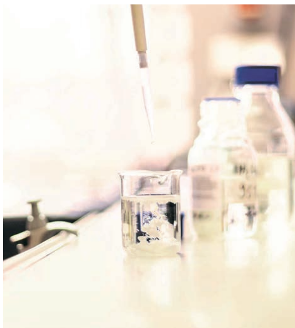
Ausfällen der Terephthalsäure (TPA) aus gelöstem PET
