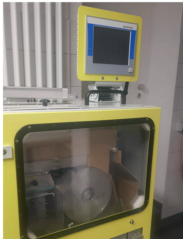
Ein modifizierter elektrostatischer Kunststoffseparator trennt Mikroplastik aus Sedimenten und Ackerböden.
