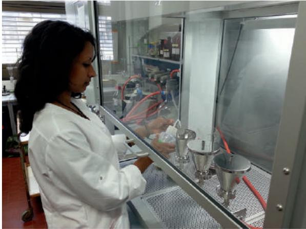
Vorbereitung der spektroskopischen Analyse: Im Labor wird eine Wasserprobe mit Mikroplastik aufgereinigt. Zum Einsatz kommt dabei ein plastikschonendes Verfahren, das auf mehreren Enzymen basiert.
