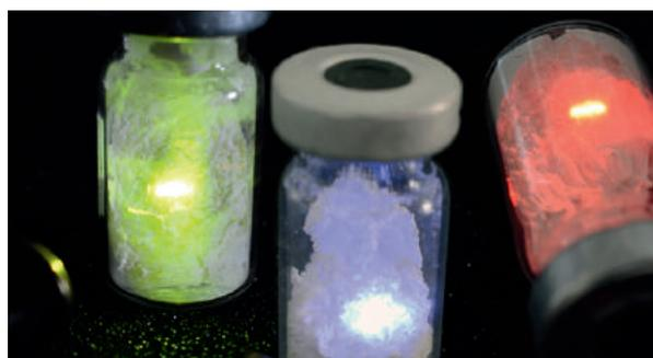
Fluoreszenzmarker sollen eine bessere Sortierung von Kunststoffverpackungen ermöglichen.
