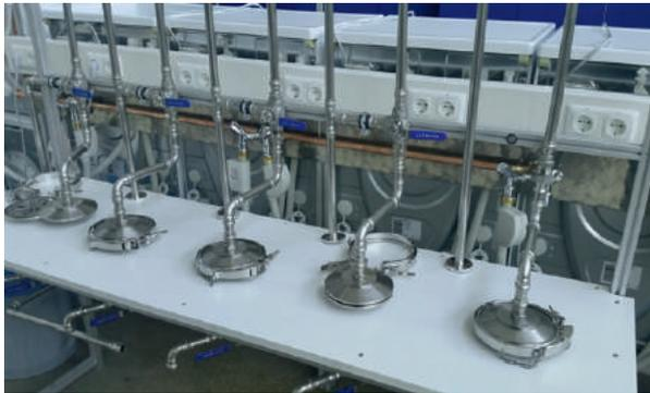
Um das Ausmaß textilen Mikroplastikeintrags zu messen, werden Waschtests vorgenommen. Hier zu sehen: Filteranlage und Waschmaschinen an der Hochschule Niederrhein.
