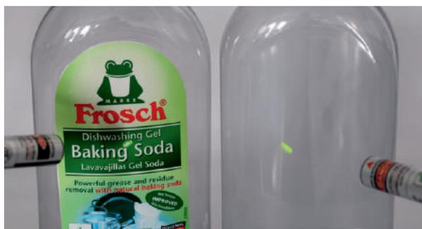
Ein spezifischer IR-Laserpointer macht den Leuchtstoff sichtbar. Der Marker kann im Etikett (links) oder im Kunststoff selbst (rechts) eingebracht werden.
