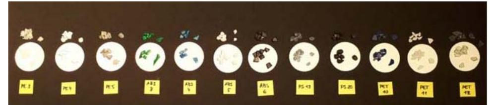
Spektrale Referenzmessungen zur Erweiterung der Kurzwelleninfrarot-Spektraldatenbank
