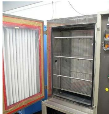
Mechanische Belastung durch Luftstrom mit Unterdrückung der Elektrostatischen Aufladung
