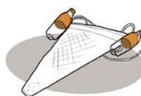
Bereiten Sie das bestellte Mikroplastiknetz zur Probenahme vor. Dazu befestigen Sie zwei leere PET-Flaschen als Auftriebskörper.
