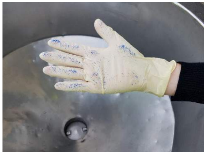
Abbildung 91: Quetschrückstände in einem Container nach Absackung von Kunststoffgranulaten
