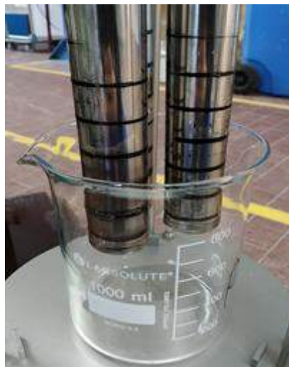
Abbildung 33: Magnetisierbare "Bottom-up"-Partikel an einem industriellen Magnetabscheider
