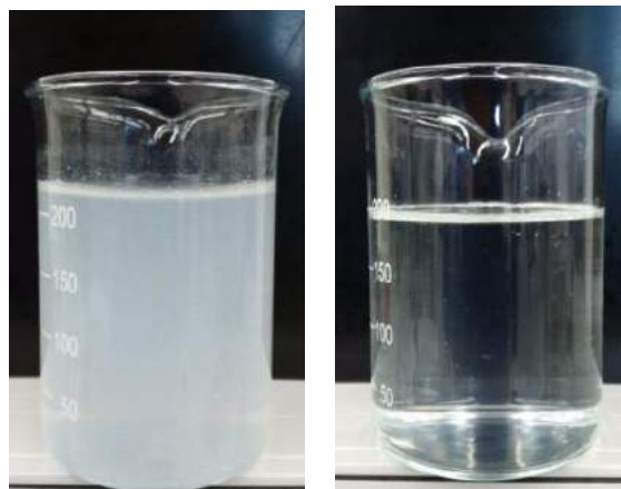
Abbildung 65: Zu- und Ablauf (v.l.n.r) des Versuches mit keramischer Ultrafiltration
