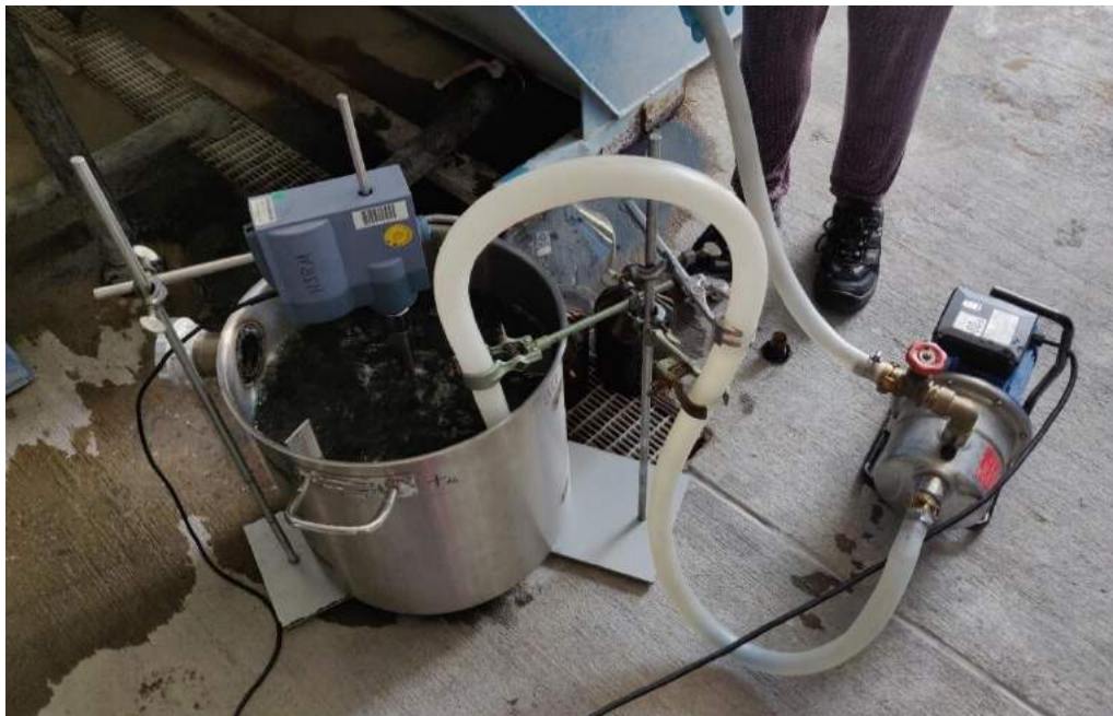
Abbildung 7: Puffergefäß mit Strömungsbrechern und Rührwerk gem. DIN 28131
