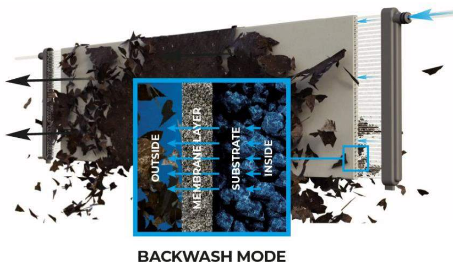
Abbildung 64: Rückspülung mit keramischen Plattenmodulen (Cembrane)
