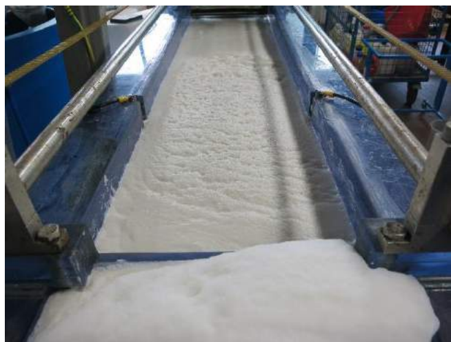
Abbildung 89: Schaum in Permeatleitung - Ultrafiltration (links), stark schäumende Elektroflotation (rechts)
