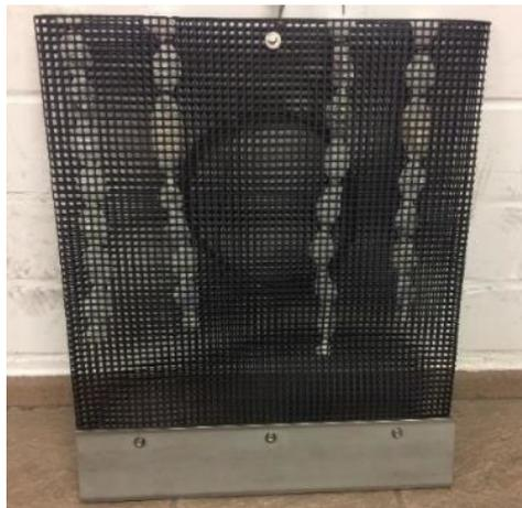
*Abbildung 20: Probenaufbau zur Exposition der ausgewählten Kunststoffe in einzelne Stufen des Klärprozesses. Die Kunststoffe sind in Gewebesläuchen gesichert und in einem Gestell zur Fixierung an der gewünschten Stelle befestigt (Abschlussbericht der Technischen Universität Darmstadt, 2021)*
