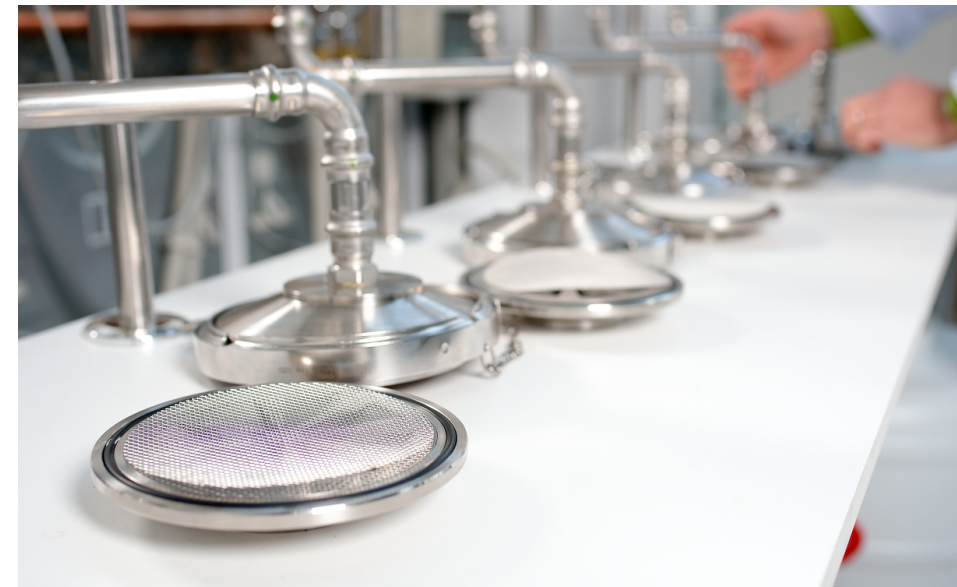
Das bei den verschiedenen Waschversuchen aufgefangene Abwasser wurden von den Forschenden der Hochschule Niederrhein durch diese Filterkaskade filtriert. Das Filtrat wurde gewogen und anschließend weiter analysiert.
