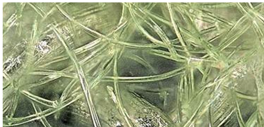
Unter dem Mikroskop zeigt sich deutlich, dass textiles Mikroplastik eine faserartige Struktur hat.
